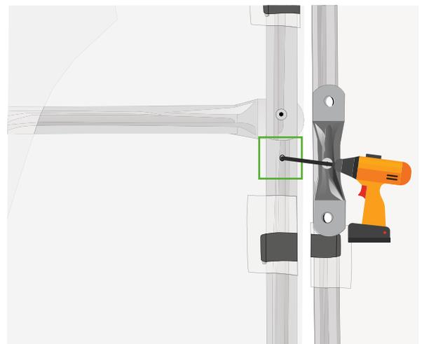
3- Visser **U de porte** (AVEC trou) avec un boulon ø6 x50mm
