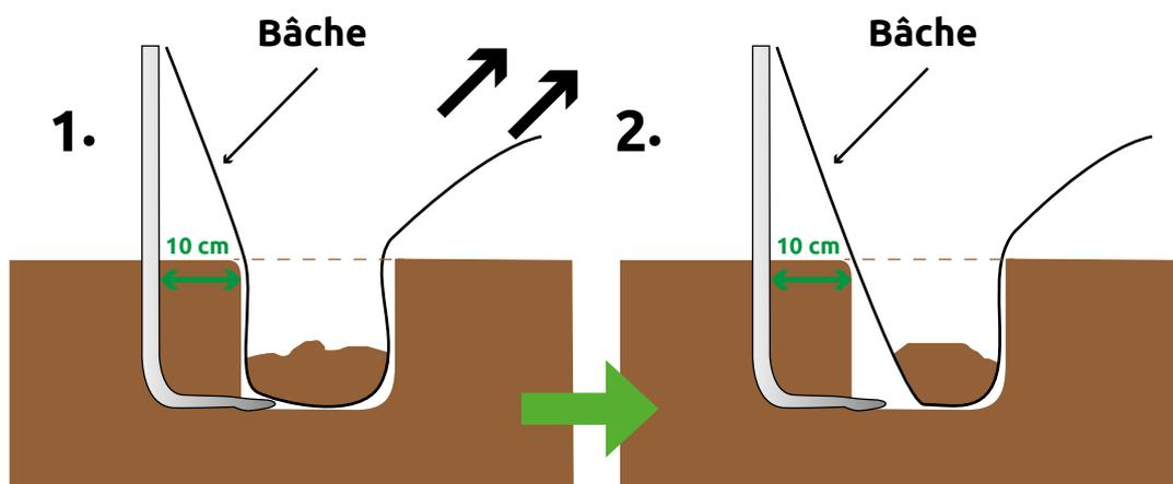
Mettre un peu de terre dans les tranchées de chaque côtés de la serre et tirer de manière à la tendre légèrement. (Le remplissage total des tranchées se fera à la fin du montage)
