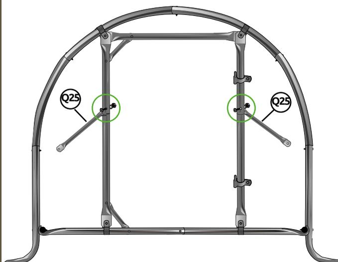
7 Fixer les deux autres extrémités des Q25 avec deux brides + boulons  $\varnothing 6 \times 30$
