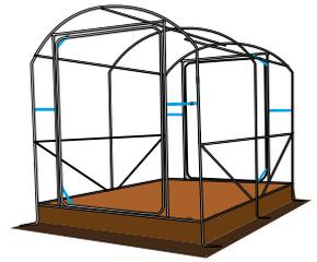
8 Fixer deux **P25 avec deux brides  $\varnothing 32$**  et les boulons  $\varnothing 6 \times 30$
