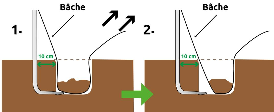
Mettre un peu de terre dans les tranchées de chaque côté de la serre et tirer de manière à la tendre légèrement. (Le remplissage total des tranchées se fera à la fin du montage)
